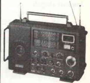
MARC NR 82 F1 Ricevitore portatile con possibilità d'ascolto dalle onde lunghe sino alle UHF in 12 bande.
